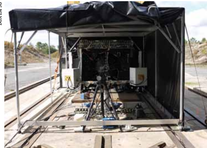
Le dispositif de mesure est constitué de deux caméras, de cibles rétro réfléchissantes (collées sur le fond du propulseur) et d'un éclairage. Les contraintes environnementales ont conduit à réaliser des choix techniques très spécifiques.
